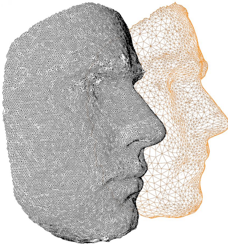
Figure 15 : Comparaison, sur le logiciel Blender®, entre un scanner de haute (à gauche) et de faible (à droite) résolution (source personnelle)
