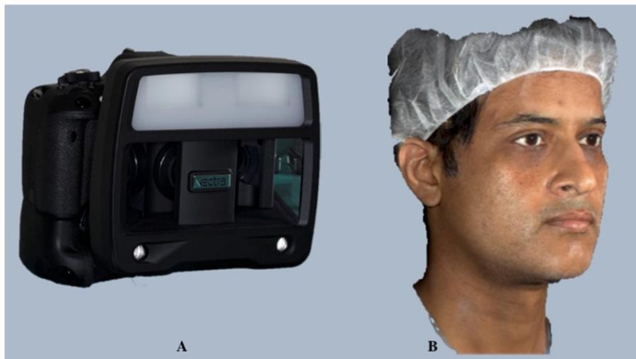
Figure 12 : Scanner stéréophotogrammétrique Vectra H1® (Canfield Scientific, 2017)(11)
